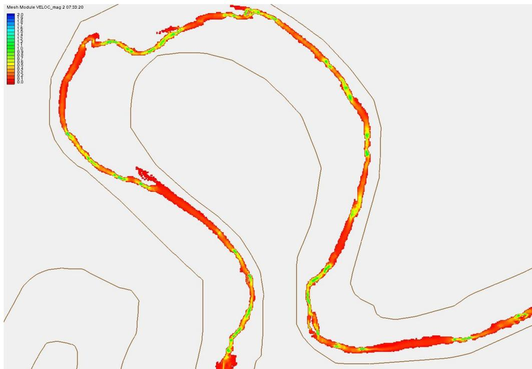
Abbildung 16: Darstellung der Fließgeschwindigkeiten bei einem Restwasser 800l/s
