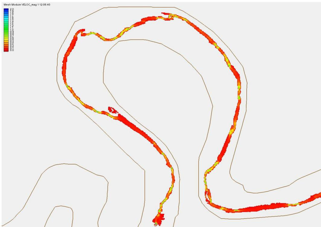
Abbildung 13: Darstellung der Fließgeschwindigkeiten bei einem Restwasser 600 l/s
